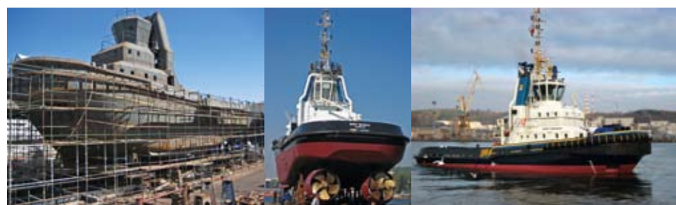
Drie stadia in de constructie van terminalsleepboot 'Smit Bioko'. Het schip werd in november 2007 opgeleverd door de werf.
