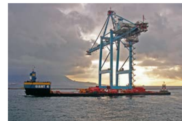
Semi-submersible barge 'Giant 4' tijdens het transport van een containerkraan in Spanje.
