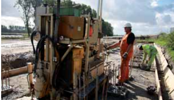
Sondering met een mini-rupsvoertuig, Weesp, Nederland.
