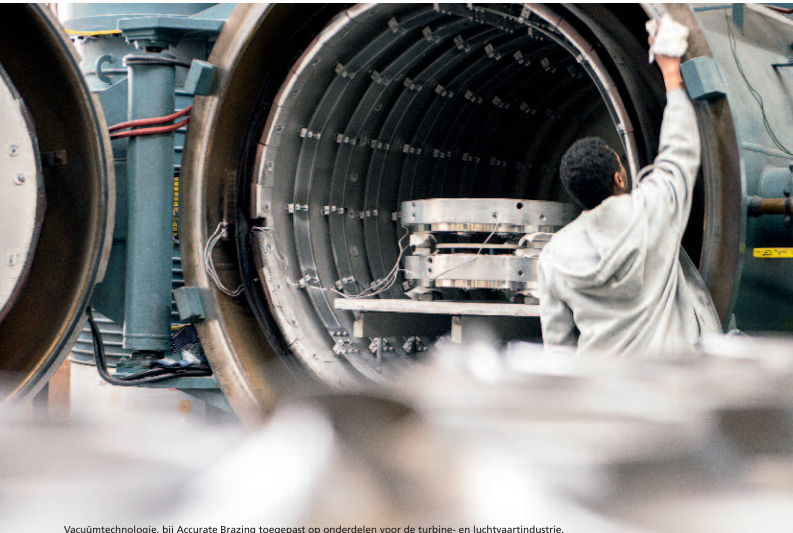
Vacuümtechnologie, bij Accurate Brazing toegepast op onderdelen voor de turbine- en luchtvaartindustrie.
